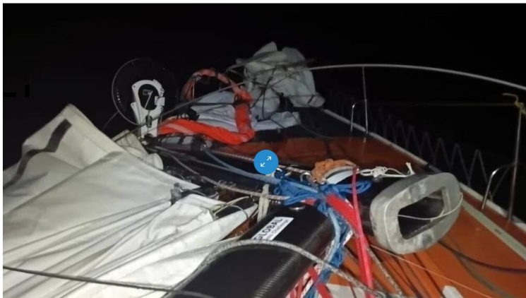
La rupture d'un des bas haubans est à l'origine du démâtage d'Ari Käsäkoski. "La tête pressée du rod au niveau de la cadène s'était détachée, malgré une inspection rigoureuse du gréement avant la Global Solo Challenge", explique l'organisation de course. | ARI KÄNSÄKOSKI / GLOBAL SOLO CHALLENGE
